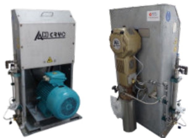
De voor- en achterzijde van een ACD verdringerpomp voor het vullen van cilinders
