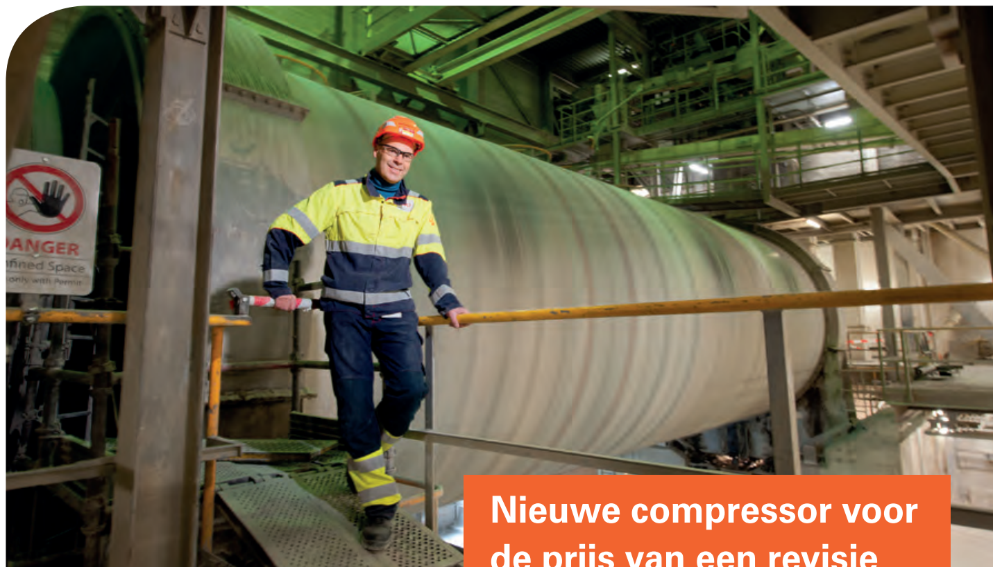
Henk van 't Hof bij het hart van de fabriek, de enorme kogelmolen waarin slakmeel en klinkermeel wordt fijngemalen tot hoogovenement.
